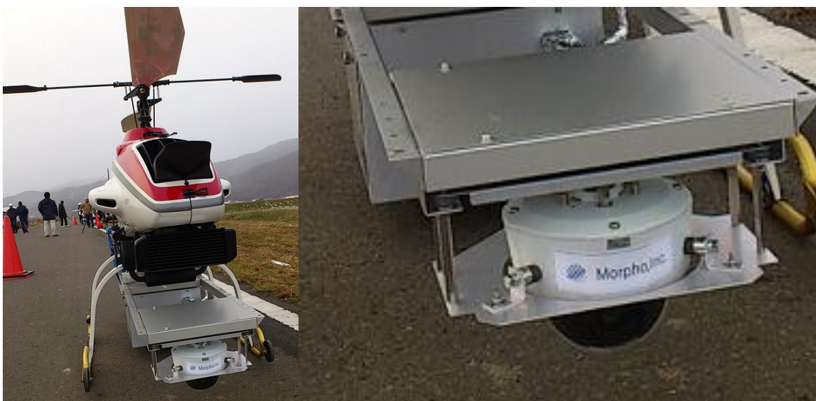
図: JAEA の自律飛行型無人ヘリコプター(左図)と搭載カメラ(右図)
